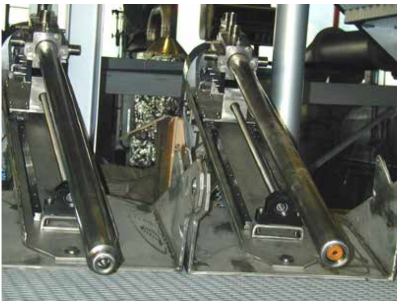
La torcia al plasma per l'inertizzazione di materiali organici o inorganici pericolosi (PCB, amianto, ceneri da trattamenti termici, fly ash)
